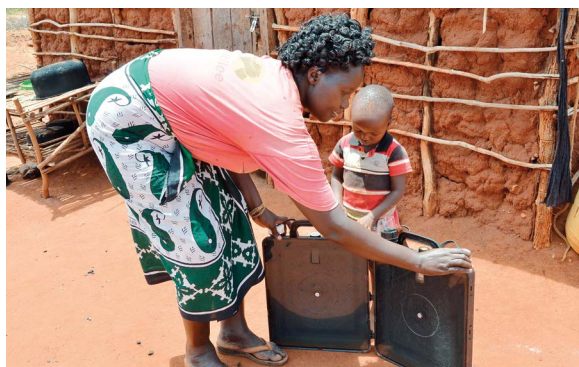
Solvatten är en kombinerad vattenrenare och vattenvärmare.
